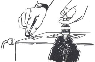
Fig. 13 Sand blasting a spark plug.
