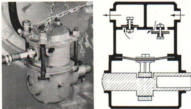
Fig. 12. — Diaphragm pump.
